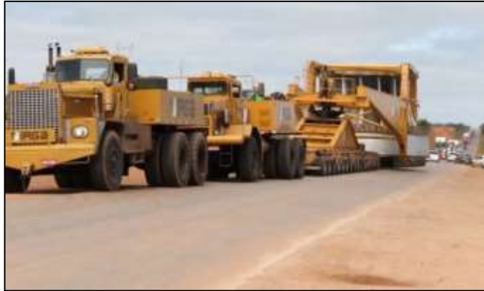
Figura 5. Transporte de rotor para da Usina Hidrelétrica de Teles Pires, pela rodovia BR-163. Fonte: Disponível em: < http://www.olhardireto.com.br/agro/noticias/exibir.asp?id=15747 > Acesso em: 05 de out. de 2014.
