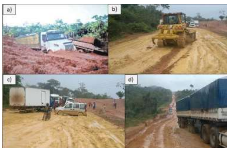
Figura 3. Condições adversas na rodovia BR-163: a) Caminhão atolado na BR-163 (Fonte: Estado de São Paulo, 27/06/2004, p. 12); b) bulldozer utilizado para desatolar veículos; c) carros, motos, caminhões parados em decorrência das condições adversas de trafegabilidade na rodovia BR-163 no Pará; d) carreta (bitrem) na rodovia BR-163, entre as cidades de Rurópolis e Santarém (PA). Fotos de Vanessa Cunha (21/10/214).
