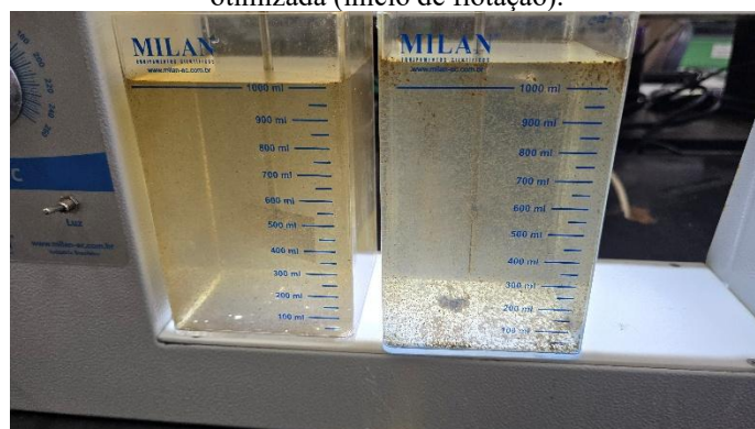
Figura 8: Comparação lado a lado: efluente com menor dosagem (esquerda, ainda turvo) e efluente tratado com dosagem otimizada (início de flotação).
