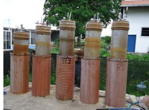
Fig.4 - Biodigestores p/coleta de gases
