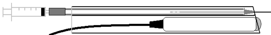
Figura 1: Aparelho de punção: verifica-se recipiente de armazenagem de amostra (palheta 0,5 mL), acoplado numa extremidade a uma agulha e a outra extremidade a uma seringa que é o módulo do aparelho de punção que encontra-se dorsalmente acoplado à guia de biópsia guiado por transdutor setorial conectado a um aparelho de ultrassonografia Falcon®.
