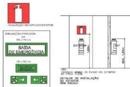
Figura 5. Detalhamento técnico da sinalização e instalação recomendada dos extintores portáteis e indicação das saídas de emergência.
