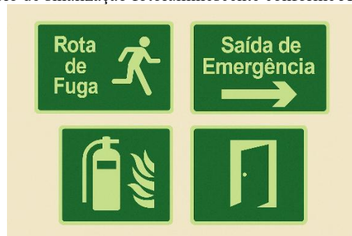
Figura 3. Exemplo de sinalização fotoluminescente conforme ABNT NBR 13434.
