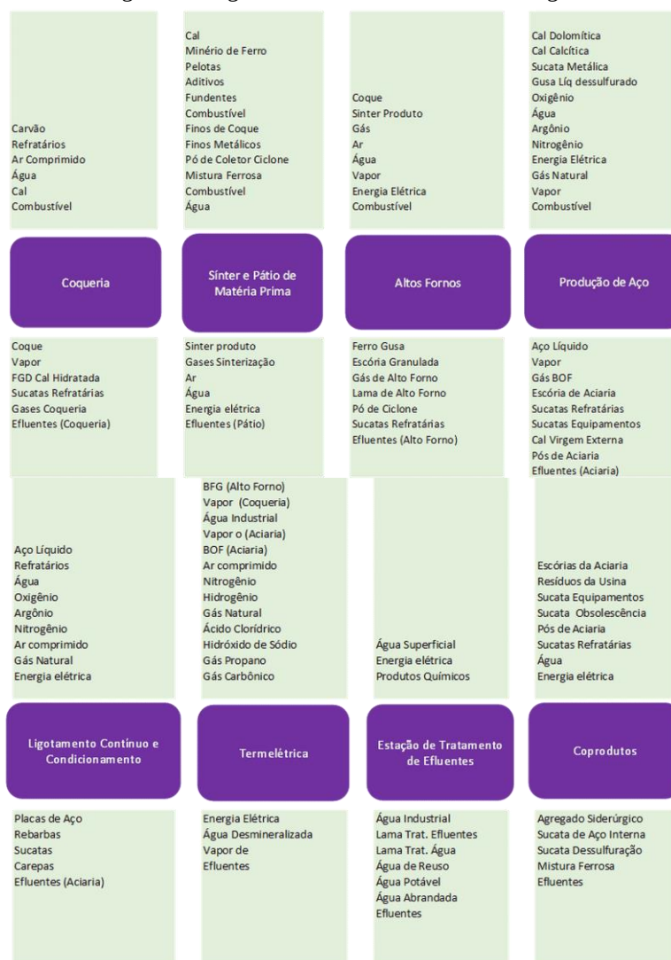
Figura 4. Diagrama de blocos Indústria Siderúrgica
