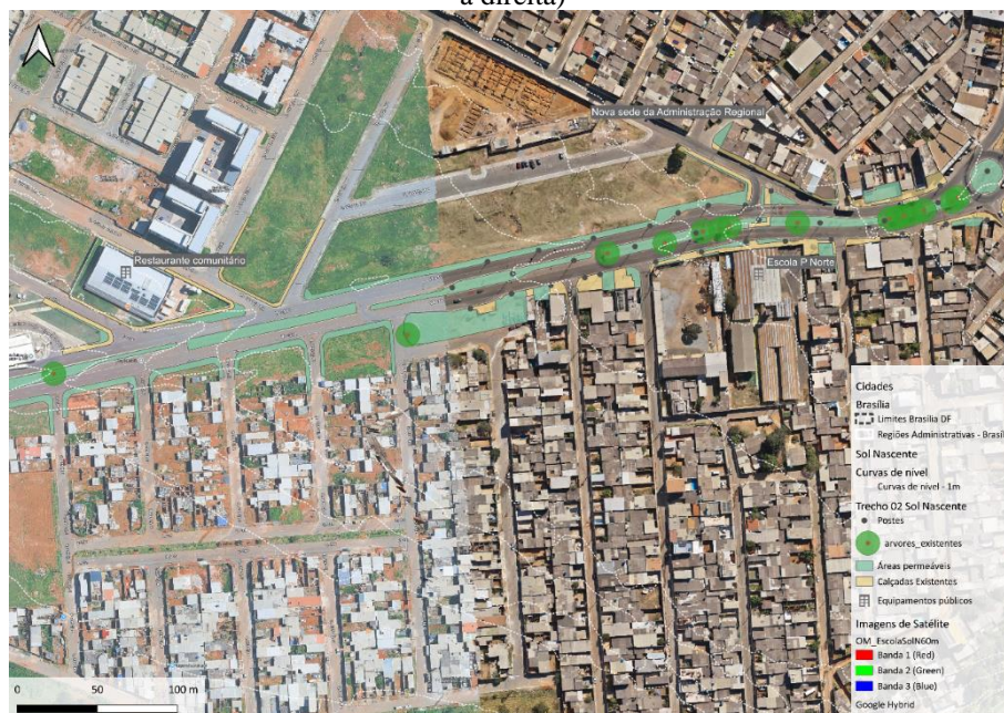
Figura 4 - Comparativo entre base cartográfica oficial (trecho à esquerda) e imagem de drone no Sol Nascente-DF (trecho à direita)
